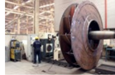
Çimento Fabrikası ID Fan 858.000 m 3 h - 867 mmSS
