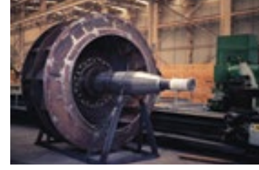
Çimento Fabrikası Rotor İmalatı 950.000 m 3 /h - 430 mmSS
