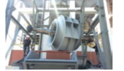
Çimento Fabrikası Farin Fırın Fanı 520.000 m 3 /h - 340 mmSS
