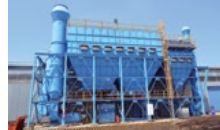
MDF Sunta Entegre Fabrikası Filtre Fanı 150.000 m 3 h - 480 mmSS
