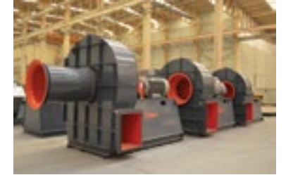
Çimento Fabrikası Klinker Soğutma Fanları 49.620-80.040m 3 /h - 630 mmSS
