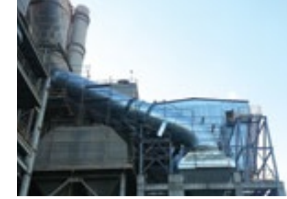
Çimento Farin Fırın Torbalı Filtresi 650.000 m 3 /h
