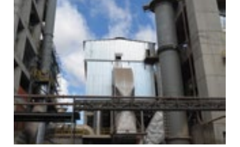
Çimento Farin Fırın Torbalı Filtresi 675.000 m 3 /h
