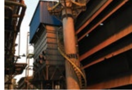
Demir ve Çelik Fabrikası Kok Kırma Eleme Tesisi Torbalı Filtresi 100.000 m 3 /h
