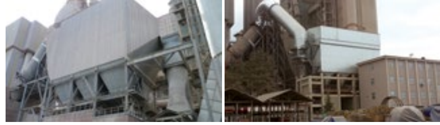
Çimento Farin Fırın ESP Dönüşüm 895.000 m 3 /h
