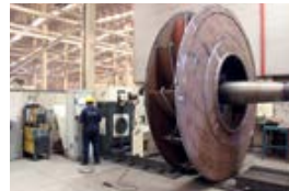
Цементный Завод – Вентилятор Фильтра Мельницы 700.000 м 3 /ч 450 mm WC
