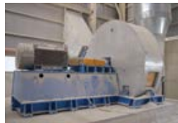
Завод По Производству Удобрений 110.000 м 3 /ч – 850 mm WC
