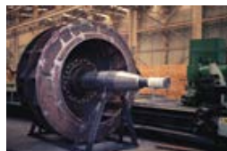
Цементный Завод – Производство Роторов 950.000 м 3 /ч – 430 mm WC
