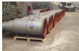
Цементный Завод – Охлаждающий Вентилятор Для Кожухов Печей 18.000 м 3 /ч – 36 mm WC
