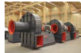
Цементный Завод – Вентиляторы Для Охлаждения Клинкера 49.620 - 80.040 м 3 /ч – 630 mm WC
